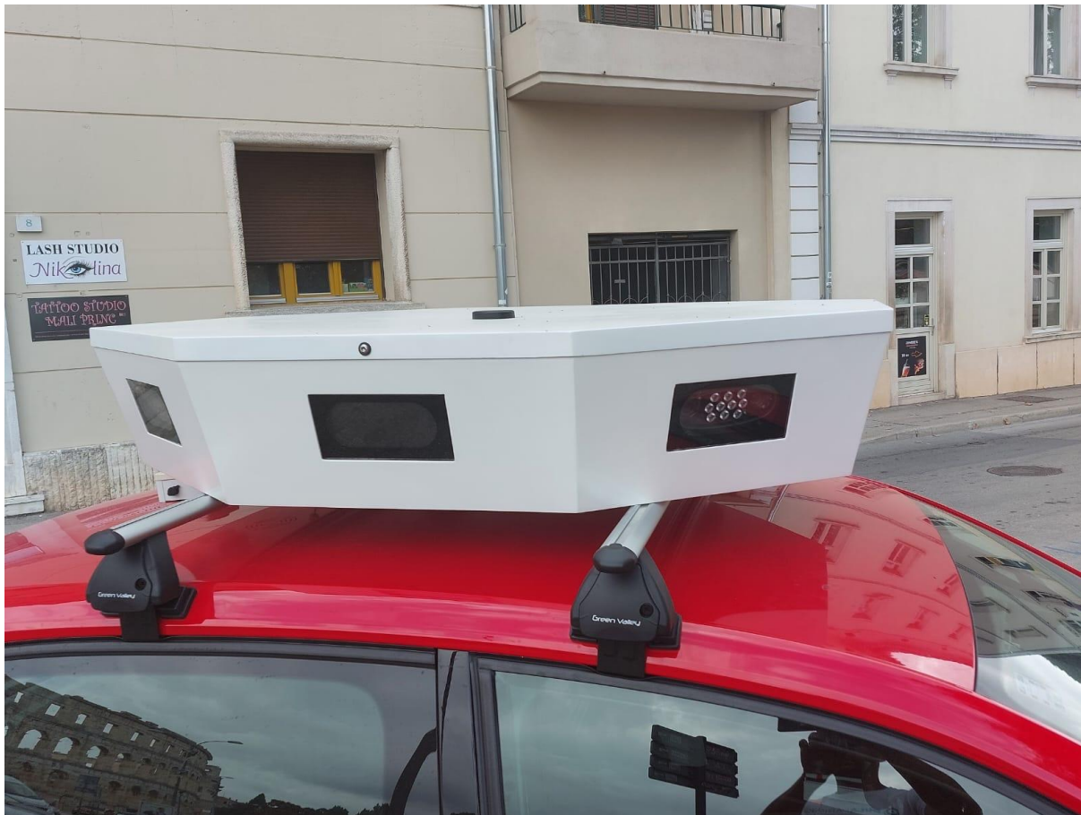
Slika 6: Izgled ANPR sustav montiranog na krov vozila
